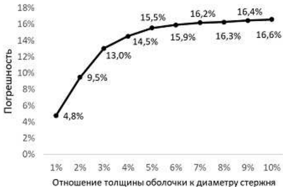
Рисунок 6. График погрешности сравнения результатов статического одноосного сжатия для однородного эффективного материала и для оболочечной модели связующего
