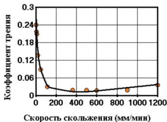
Рис 3: Зависимость коэффициента трения от скорости скольжения пары трения в среде масла марки Автол 18
