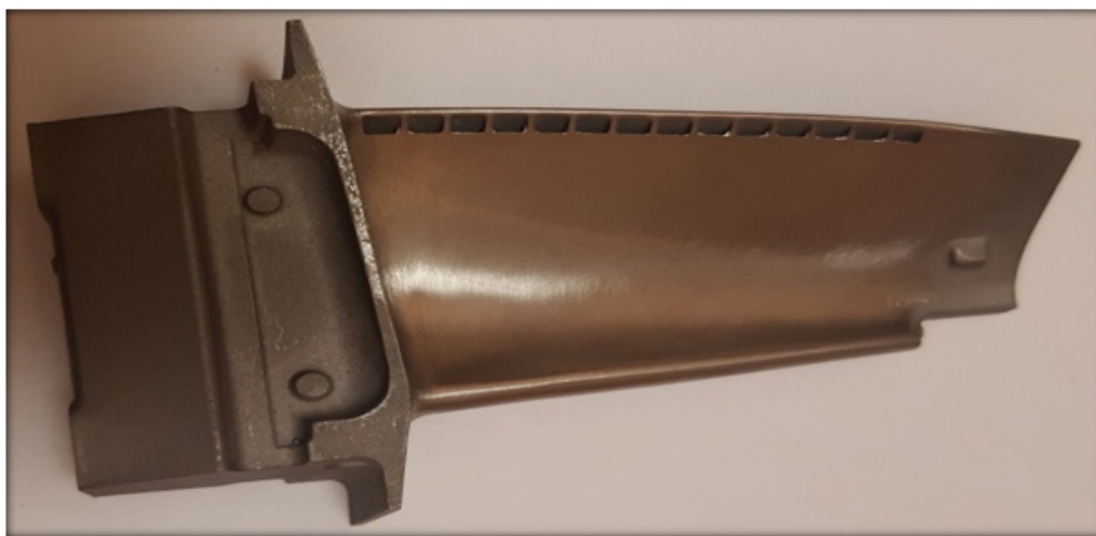
Рис. 1: Турбинная лопатка из жаропрочного сплава
