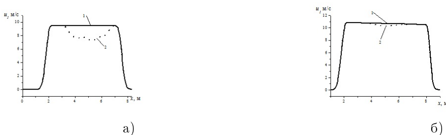
Рис. 5: Продольная составляющая скорости газа при распространении ударной волны в газозвесь с дисперсностью частиц — d=4 мкм: рис.5,а и в газозвесь с размером частиц d=400 мкм:рис.5,б; t=11 мс. Кривые 1 и 2 соответственно электрически нейтральная и заряженная газозвеси.
