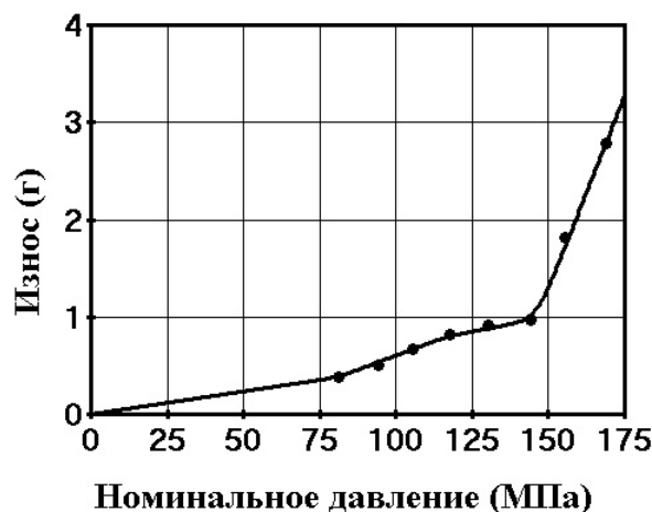
Рис. 8: Зависимость износа стали Р18 от номинального контактного давления.
