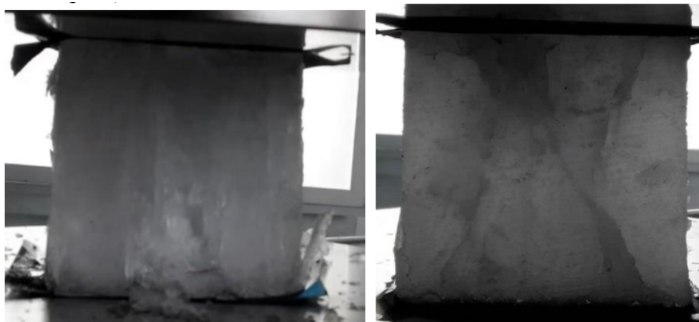
Рис. 4: Картины разрушения ледяного образца в натуральных экспериментах.
