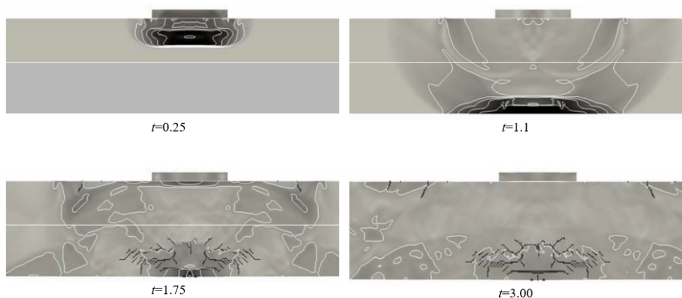
Рис. 1: Нормальный удар пластины в разные моменты времени. Черными линиями отмечены образовавшиеся трещины, белыми — изолинии скоростей. Насыщенность цвета соответствует также модулям скоростей.
