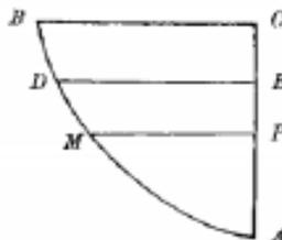
Soit  $AM=s$ ,  $AP=x$ , et soit  $t$  le temps que le mobile emploie à parcourir l'arc  $DM$ . D'après les règles de la mécanique on a  $-\frac{ds}{dt} = \sqrt{a-x}$ , donc  $dt = -\frac{ds}{\sqrt{a-x}}$ . Il s'ensuit, lorsqu'on prend l'intégrale depuis  $x=a$  jusqu'à  $x=0$ ,
