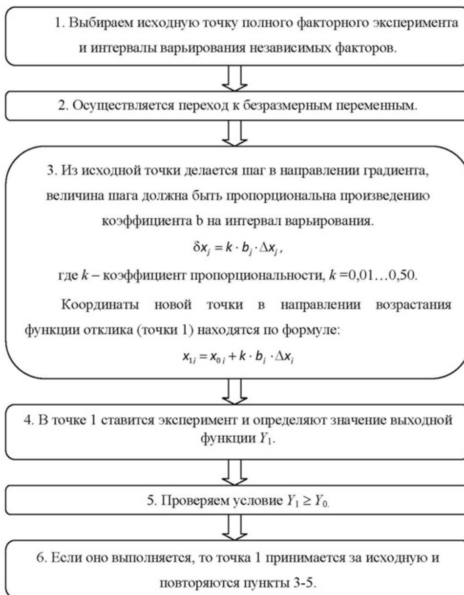
Рис. 5: Блок-схема расчета крутого восхождения
