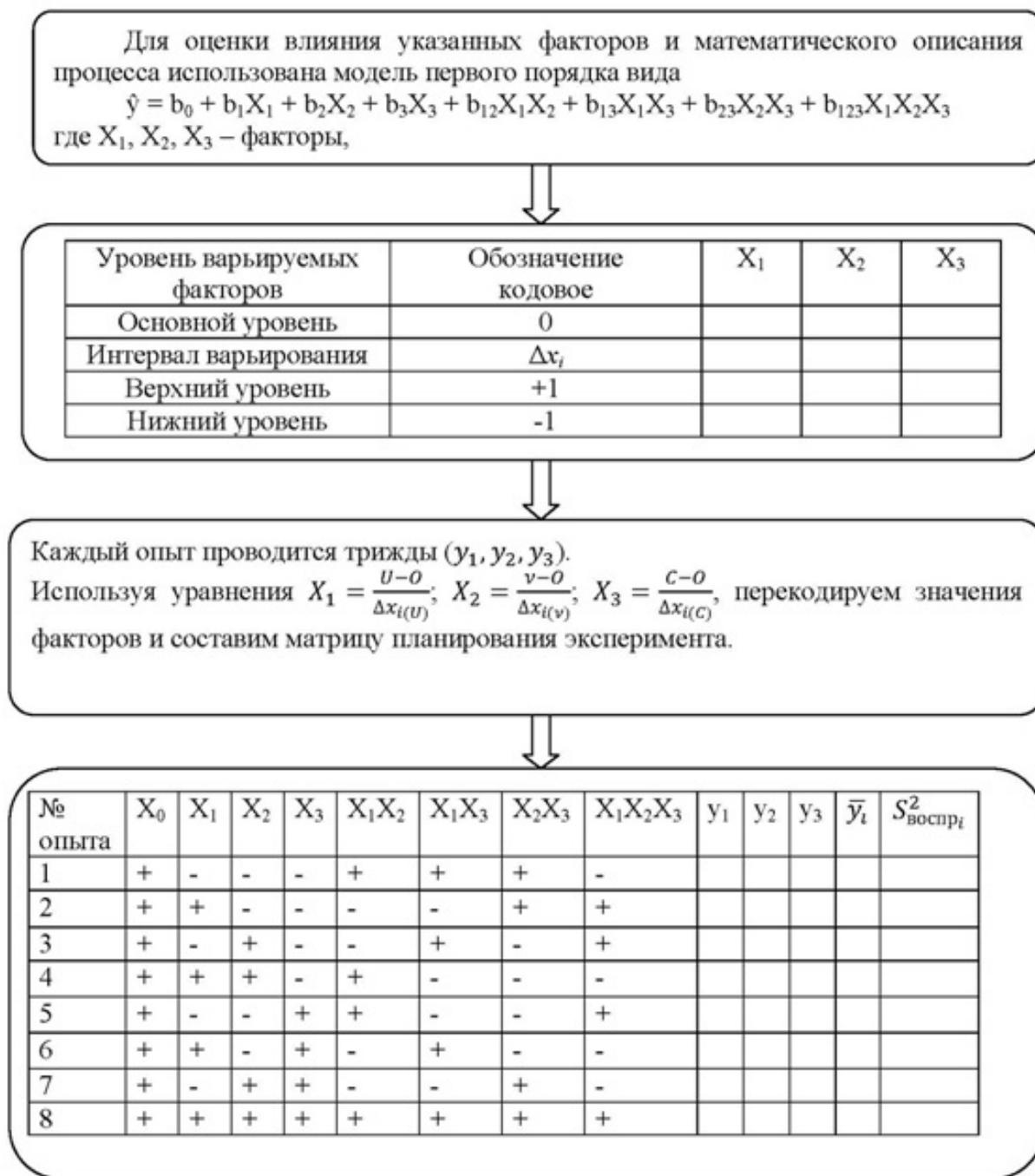
Рис. 3: Блок-схема постановки полного факторного эксперимента (1 этап)
