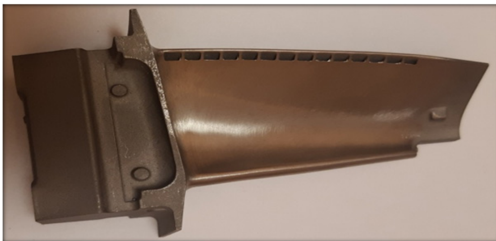
Рис. 1: Турбинная лопатка из жаропрочного сплава
