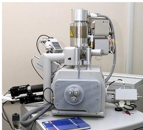
Электронно-ионный сканирующий микроскоп «Quanta 600 FEG»
