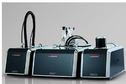
Лазерный анализатор размеров частиц «Analysette 22 NanoTec»
